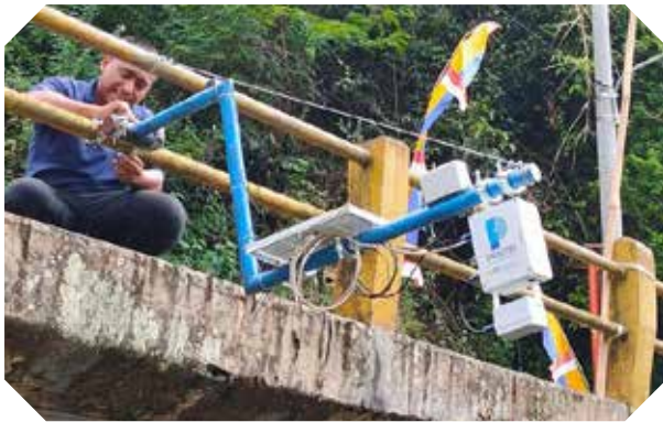
FMIPA UI memasang Pantir, teknologi pemantau curah hujan di Kecamatan Sumedang Selatan, Jawa Barat. FMIPA UI installs Pantir, a rainfall monitoring system, in South Sumedang Regency, West Java.
