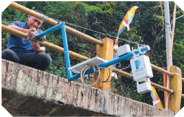
FMIPA UI memasang Pantir, teknologi pemantau curah hujan di Kecamatan Sumedang Selatan, Jawa Barat.
